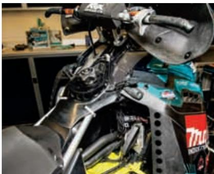
Правила открытого класса не запрещают облегчать конструкцию снегоходов. Вы можете заметить отсутствие, изменение или глубокую модификацию некоторых элементов. Все это ради снижения массы и повышения энерговооруженности. На данный снегоход установлен маленький алюминиевый топливный бак, заполненный высокооктановым бензином.
